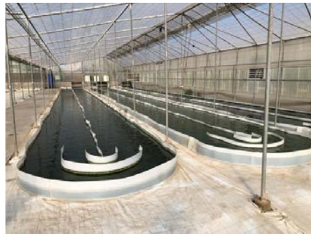
Fig. 1: Raceway bioreactor at Universidad de Almeria, Almeria
